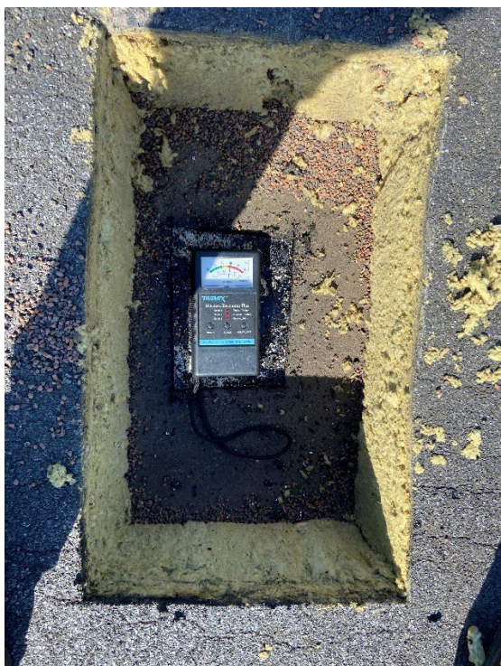
Foto 7.25. Fugtmåling af tagopbygning
